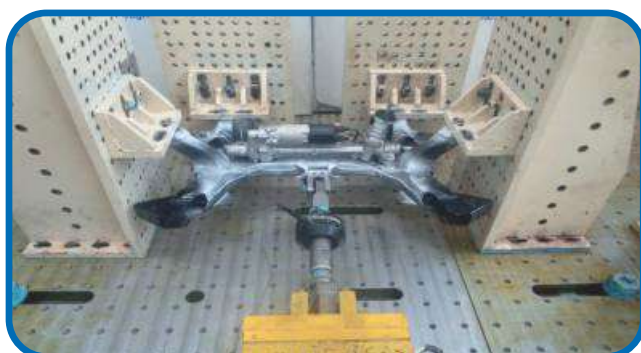
फ्रंट तथा रियर उप-फ्रेमों की स्थैतिक कठोरता और मजबूती परीक्षण
