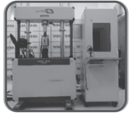
फेटिंग कैरेक्टराईजेशन के लिए सर्वो हायड्रोलिक परीक्षण
